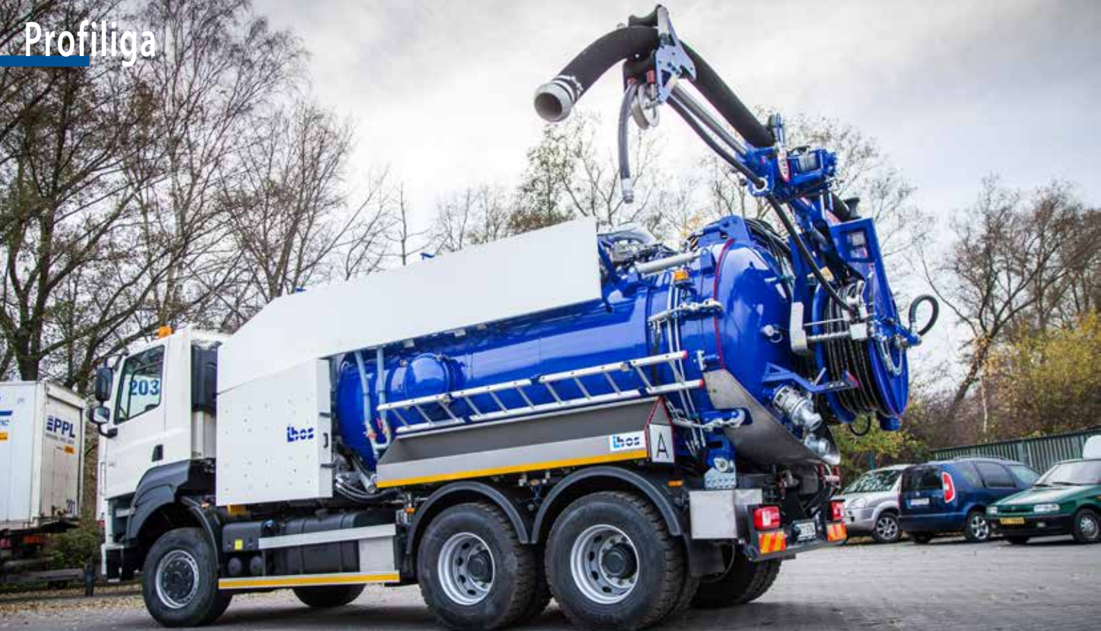
Recyklační nástavba KOMBO RE. Tato technologie umožňuje nasáté kaly s vodou recyklovat a následně s recyklovanou vodou dále čistit potrubí
