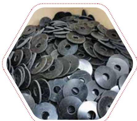
vysekávání plochého těsnění pomocí matrice (sériová výroba)
