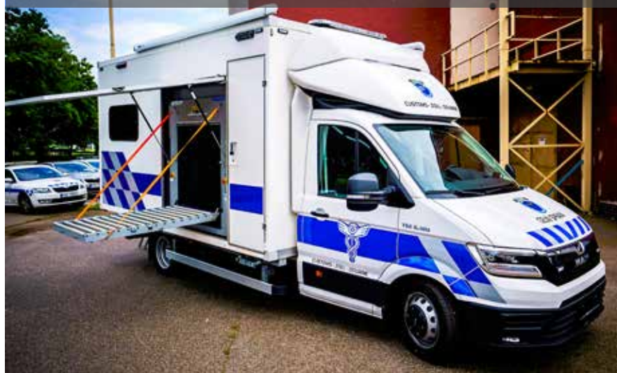
Mobilní dvoupohledový zavazadlový rentgen dodávala společnost JÍŠA společně s firmou PCS Generálním ředitelství cel. Žádný jiný takový na světě nenajdete
