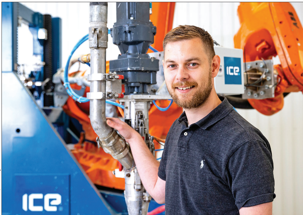
Projektový šéf společnosti ICE Industrial Services Dominiček Stupka ukazuje automat pro 3D tisk betonových konstrukcí.
