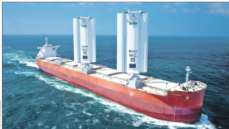
NÁKLADNÍ LOŽ UŠETŘÍ palivo díky plachtám vysokým až 37 metrů, které umí na paluby montovat norská firma Yara Marina. První plavidlo Pyxis Ocean pronajaté společností Cargill po úpravě opustilo doky v Číně. V průměru ušetří jeden a půl tuny paliva denně. (zr)
